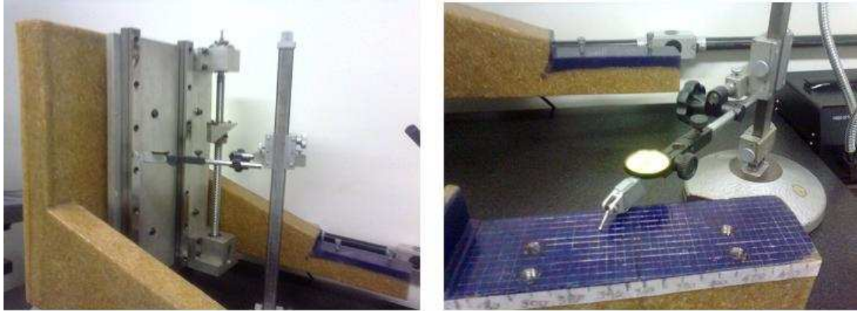
Figura 12 – Mapeamento dos desvios no assentamento do eixo Y
